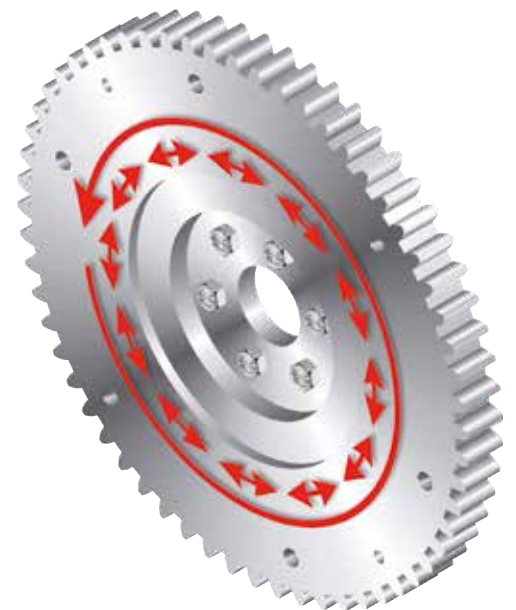
Bewegungsmustereiner Schwungscheibe mit überlagerter Drehschwingung.
