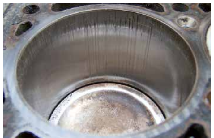
Riefen in der Zylinderlauffläche erhöhen die Menge des Öls im Brennraum bei gleichzeitig nachlassender Kompression.
