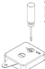
Gebruik een tweede kompas als referentie. Een Plastimo handpeilkompas is hiervoor het beste op voorwaarde dat deze niet beïnvloed wordt door magnetische storing. De Noord/Zuid schroefjes corrigeren de Noord/Zuid koers en de Oost/West schroefjes de Oost/West koers.
