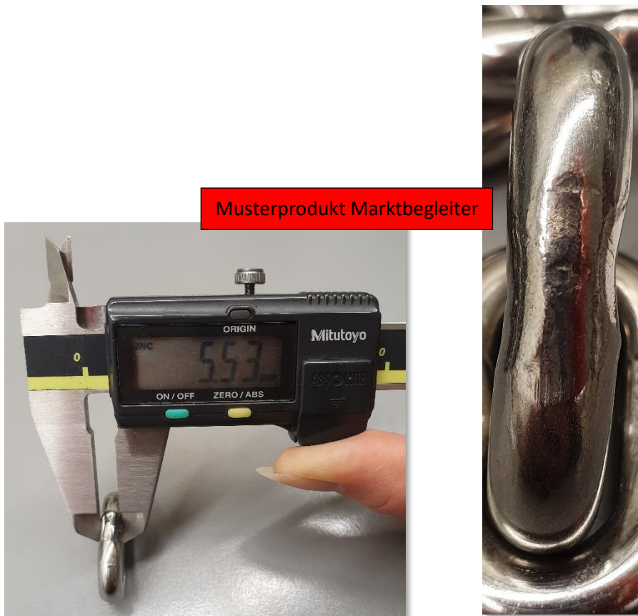
Bild 11 & 12: MUSTERPRODUKT MARKTBEGLEITER 6x18,5mm Messung der Schweißnaht
