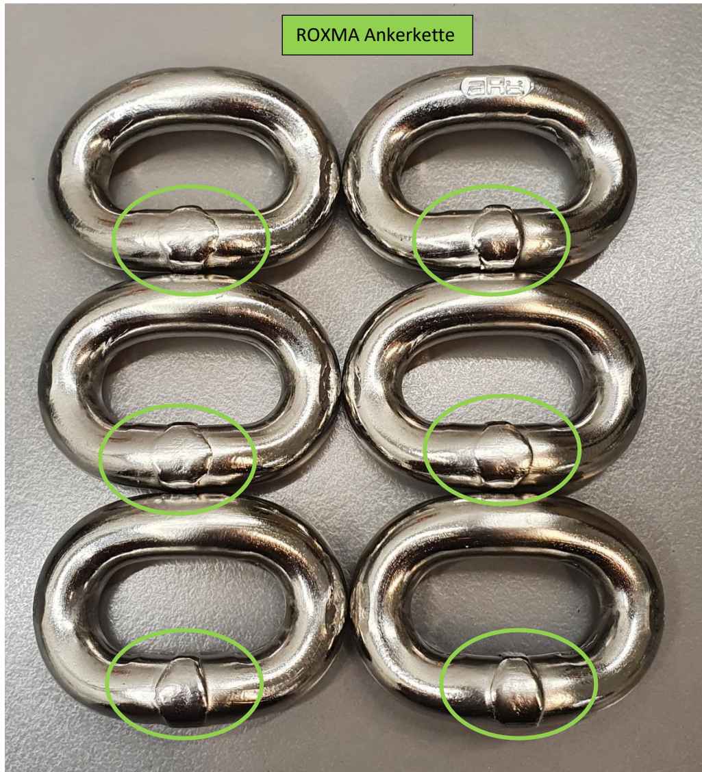
Bild 7: ROXMA Kettenglied -10x28 mm- nach Biegeversuch
