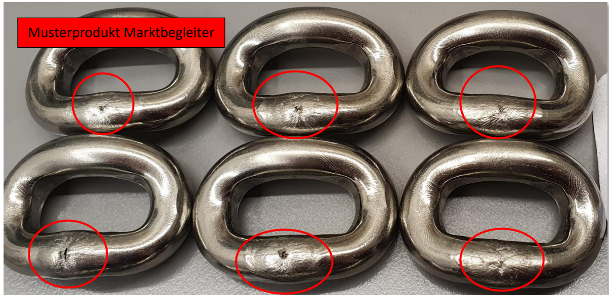
Bild 6: Musterprodukt Marktbegleiter -10x28 mm- nach Biegeversuch
