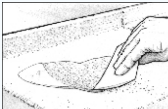
Abbildung 29 Verteilen Sie das Epoxidharz mit einem Kunststoffspachtel auf der Gewebeoberfläche.
