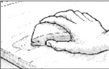
Abbildung 23 Schleifen Sie ausgehärtete Spachtelmasse auf die gewünschte Kontur.
