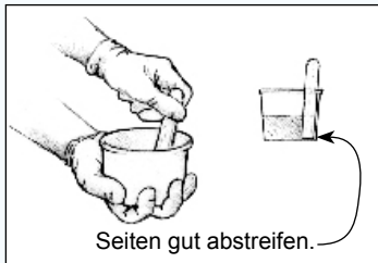
Abbildung 3 Mischen Sie das Harz und den Härter gründlich für zwei Minuten, bei kälteren Temperaturen länger.
